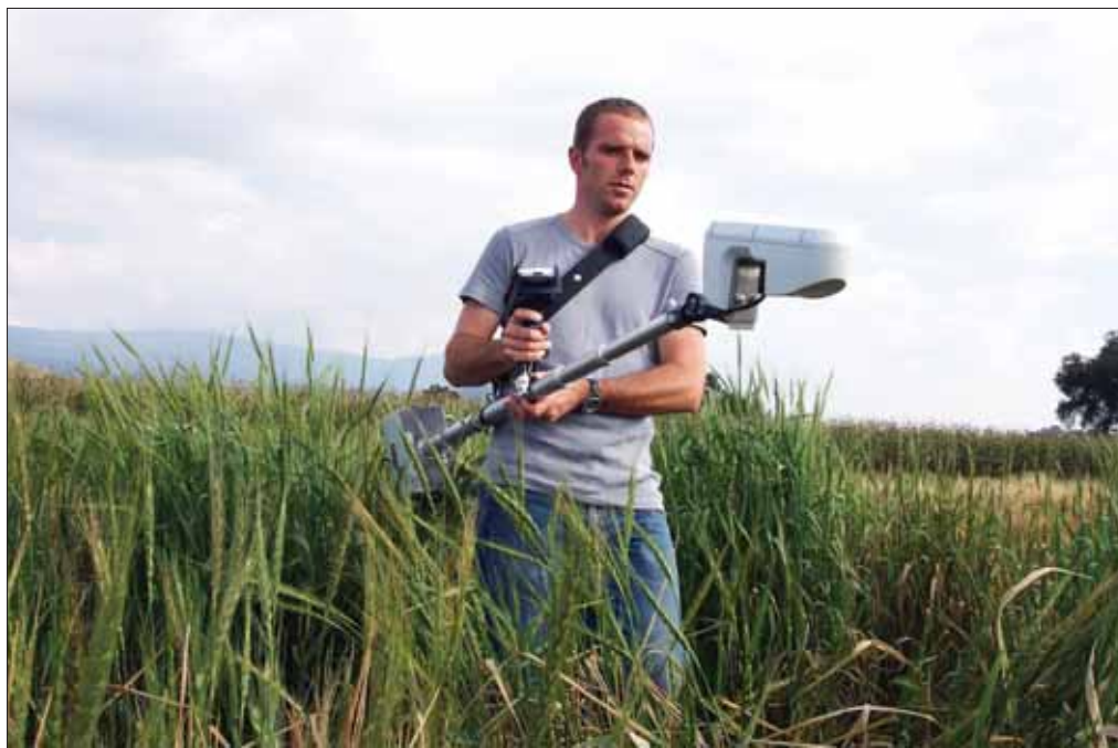
Ручной N-сенсор: альтернативой химическому определению подвижного азота в почве стали сегодня азотные сенсоры. С помощью этих приспособлений можно производить экспресс-диагностику потребности культур в азоте по их цвету.
